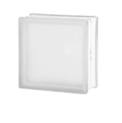
Sklobetónová tvárnica LUXFER (BSH20 CLEARVIEW SAHARA 2S), rozmer 190x190x90 mm, číra tvárnica bez dekoru, nepriehľadná, obojstranne pieskovaná, použitá ako telo predajného pultu, nadväzuje na používanie luxferov v celom objekte, možnosť LED nasvietenia spoza pultu
