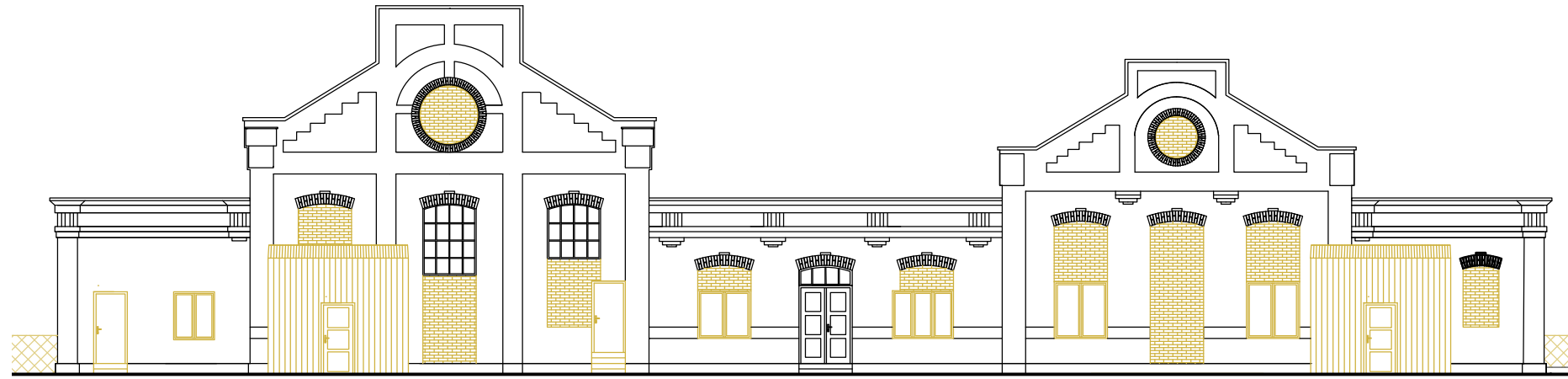
VÝCHODNÍ POHLED _ STÁVAJÍCÍ STAV a BOURÁNÍ
