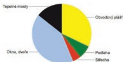
Teplotní ztráty jednotlivými konstrukcemi - po zateplení
