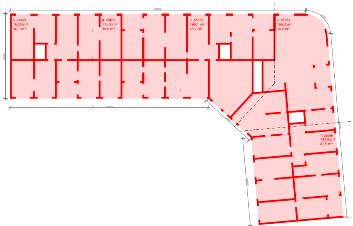
Obr. 4: Záběry betonáže vodorovných konstrukcí
