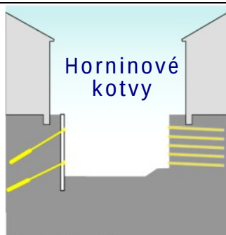
Kotvení a hřebikování
